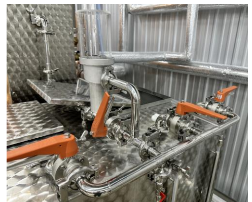
多彩なオプション: 分割受槽、分岐配管、アルコールメーター、ウロコバフ仕上げ
