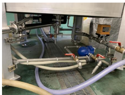
液出口が中心に有るので、 最後迄液が残りにくい
